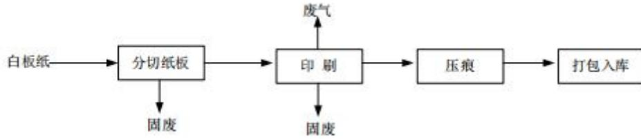
图 2-3 工艺流程及产污环节图
